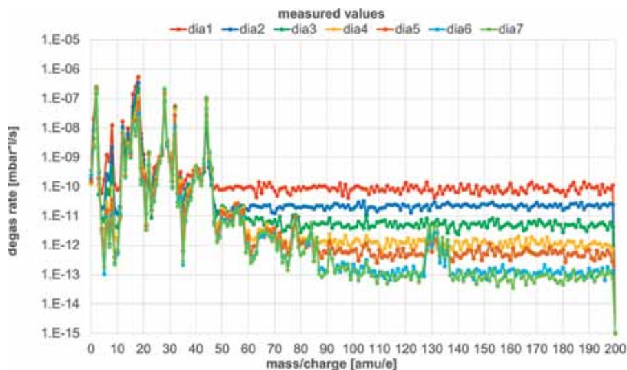
Figuur 3 Typisch massaspectrum voor de verschillende diafragma's. Bij de kleinste diafragma's 6 en 7 worden kalibratiegas componenten ^{84}\text{Kr} en ^{132}\text{Xe} duidelijk zichtbaar. Kennelijk lekt de klep naar de kalibratiegascilinder. Het spectrum ziet er overigens verder schoon uit.
