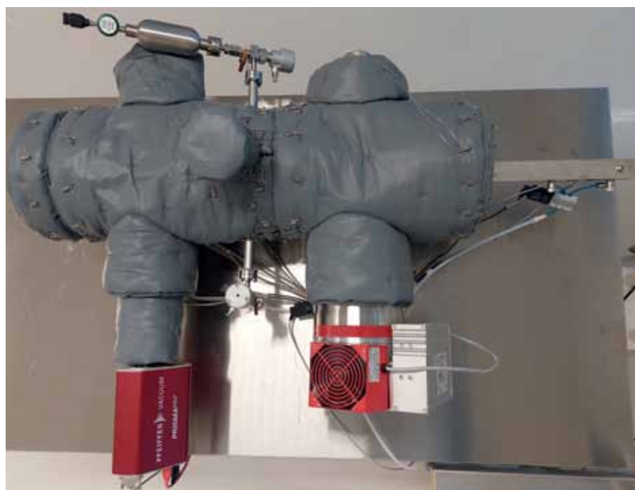
Figuur 1 Bovenaanzicht van de RGA-opstelling ingepakt met uitwendige verwarmingselementen en thermische isolatie.
