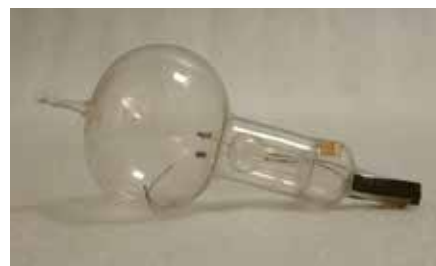
Figuur 1 Thomas Edison gebruikte deze kooldraadlamp bij de eerste openbare demonstratie van zijn beroemdste uitvinding, de eerste praktische elektrische gloeilamp. Deze demonstratie vond plaats in zijn laboratorium in Menlo Park op oudejaarsavond 1879. Om de buis leeg te maken, werd een Sprengelpomp aangesloten op de open rechterzijde van de buis. (Foto: Smithsonian Institution, www.americanhistory.si.edu )
