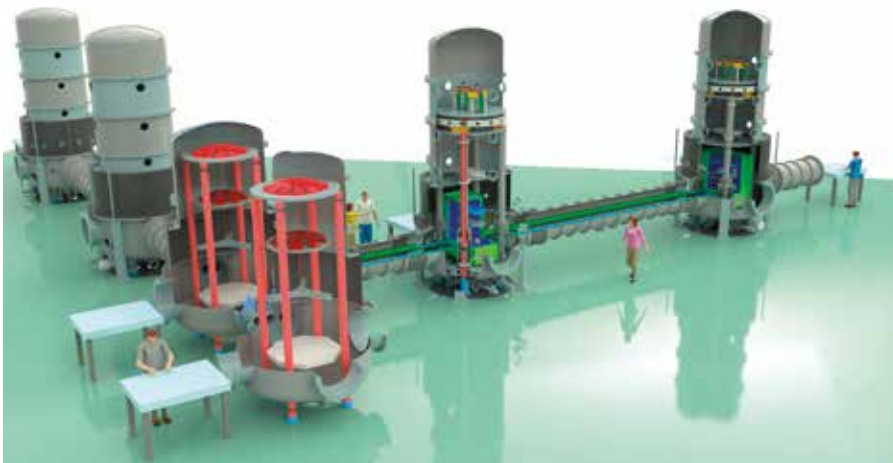
Impressie van ETpathfinder: een opstelling met twee armen en meerdere torens met trillingsvrije tafels voor de laser, detector en spiegels, die worden gekoeld tot -153\text{ }^{\circ}\text{C} en in de toekomst wellicht zelfs tot -263\text{ }^{\circ}\text{C} .
