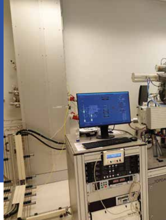
Jochem Paalman bij de Topdamper, die TCO heeft gebouwd voor physical vapour deposition: “We werken op de afdeling met een heel breed gamma aan vacuüms. (Foto: UT)”
