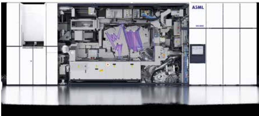
Figuur 1. Het werkpaard van EUV-lithografie, de NXE scanner; met het lichtpad in paars, de bron rechtsonder, het masker bovenin en de wafer onderin.
