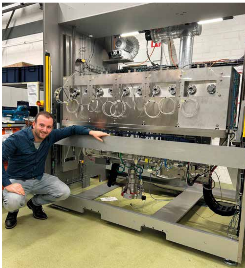
Mark Driessen bij een klantspecifieke hoogvacuüm-uitstookoven (infrarood) met mogelijkheid voor restgasanalyse.
