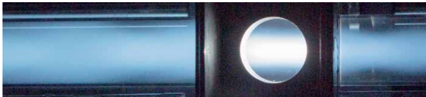
Figuur 1 Foto van een CO 2 microgolflasma in het DIFFER-lab.
