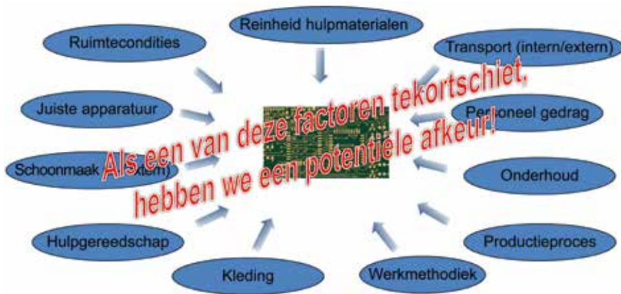
Invloedfactoren bij printplaatproductie in relatie tot stofbeheersing. (Bron: Thales Nederland)
