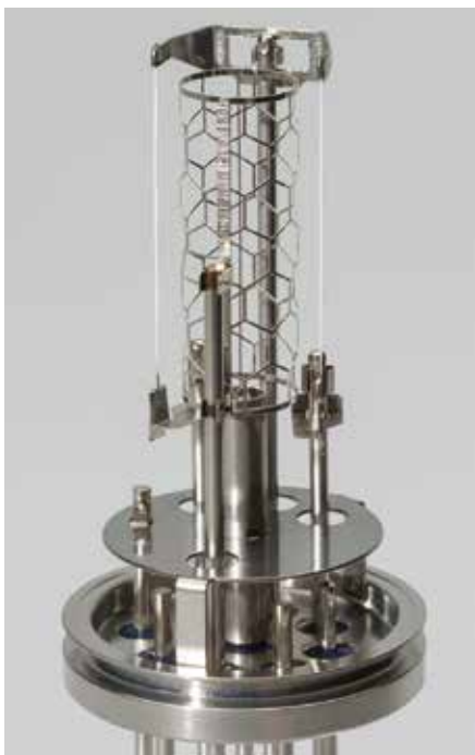
Figuur 2. Een voorbeeld van een Bayard-Alpert-ionisatiemeter met een hete gloeidraad. (Beeld: INFICON)
