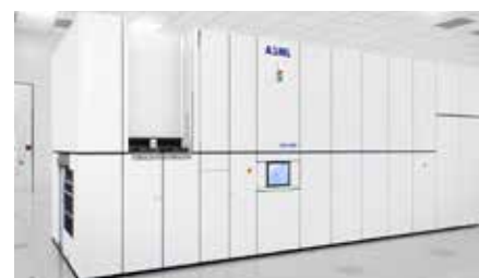
In een EUV-machine van ASML is een vacuümomgeving nodig; PFAS-materialen spelen daarin een belangrijke rol.
