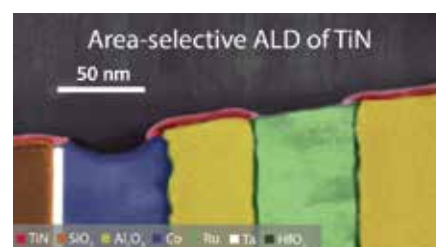
Demonstratie van plaats-selectieve depositie van TiN op SiO 2 - en Al 2 O 3 -oppervlakken, ten opzichte van Co- en Ru-oppervlakken waar geen depositie heeft plaatsgevonden [3].
